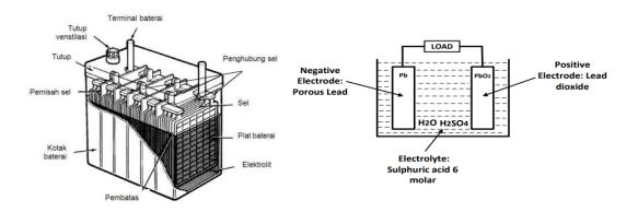
Gambar 2. 11 Kontruksi Baterai Lead Acid
