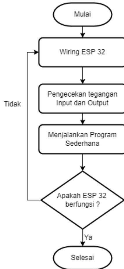
Gambar 3. 10 *Flowchart* Pengujian Mikrokontroler ESP 32
