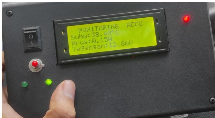
Gambar 3. 42 Pengujian Sistem Monitoring pada LCD
