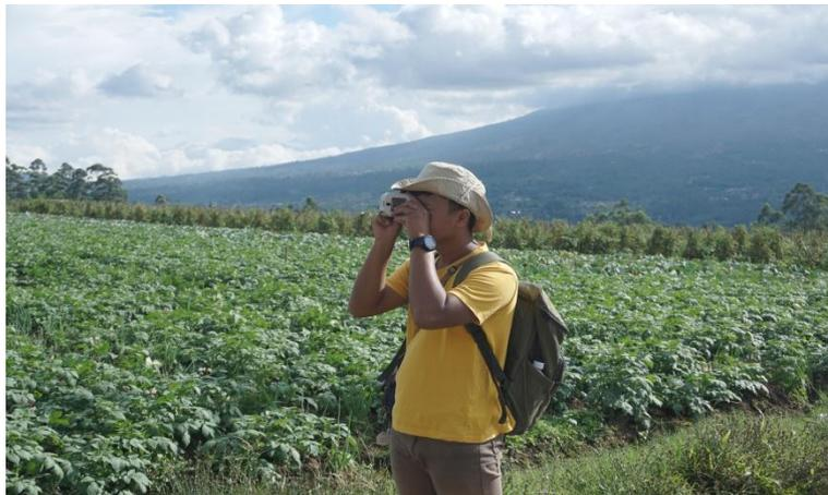
**Pengukuran Kemiringan Lereng (*Slope*) Menggunakan Kompas Geologi**
