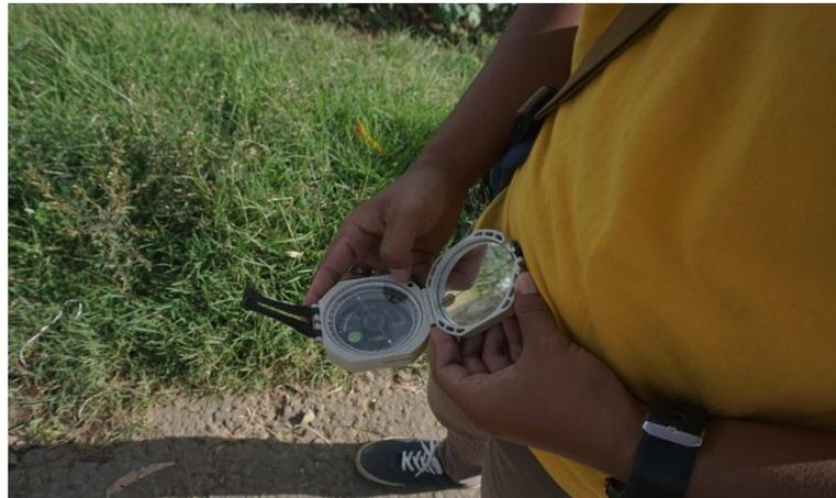
**Pengukuran Azimuth Menggunakan Kompas Geologi**
