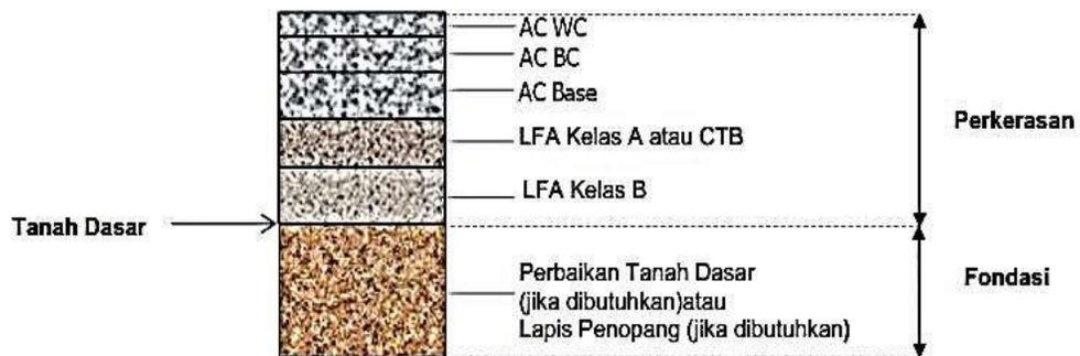
Gambar 2.26 Perkerasan Lentur Pada Permukaan Tanah Asli
