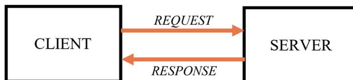
Gambar 2. 18 Skema *Client-Server* pada Modbus TCP
