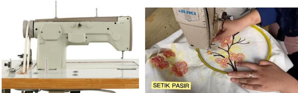
**Gambar 2.2 Mesin Bordir Manual**
