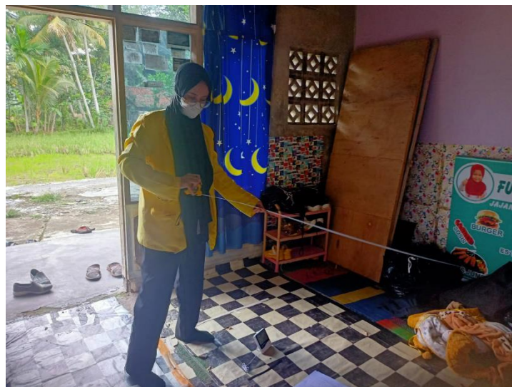
Pengukuran ventilasi dan luas lantai menggunakan roll meter
