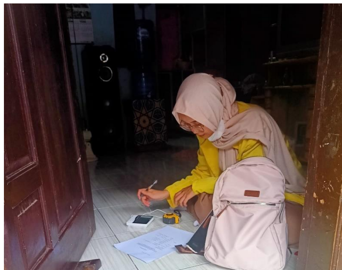
Pengukuran suhu dan kelembaban menggunakan alat thermohygrometer
