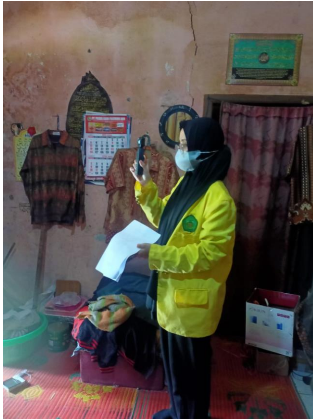
Pengukuran pencahayaan alami menggunakan luxmeter
