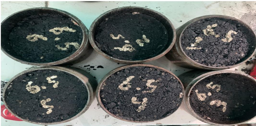
Gambar 3. 33 Benda Uji Setelah Ditumbuk
