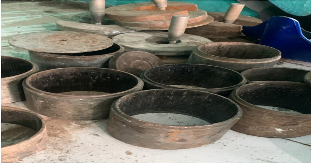
Gambar 3. 28 Cetakan Benda Uji
