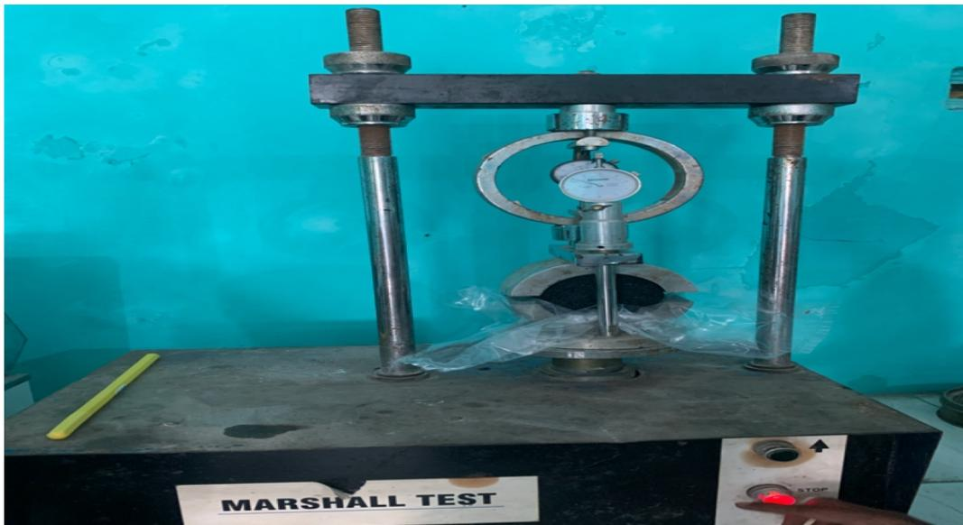
Gambar 3. 36 Benda Uji Pada *Marshall Test*
