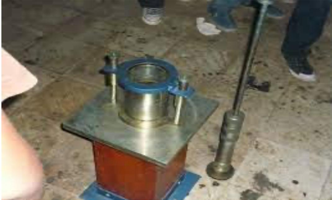
Gambar 3. 7 Cetakan Benda Uji Silinder
