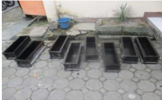
Gambar 5. Cetakan Plat Beton Bertulang Bambu
