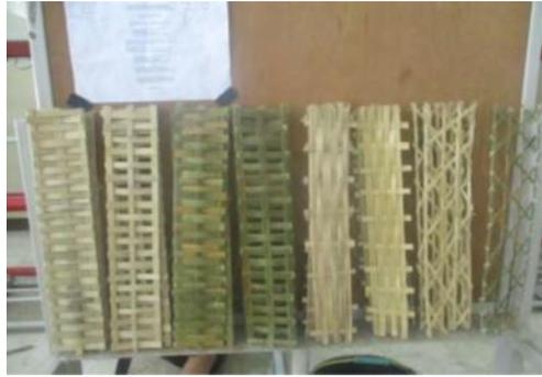
Gambar 4. Contoh Anyaman Silang Bambu untuk Tulang Beton
