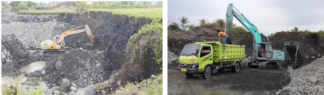
**Gambar 6.15. Alat Berat yang digunakan Pada Penambangan Pasir Galunggung**
