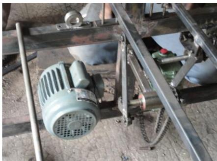
Gambar 8 :Perakitan Mesin Penggerak
