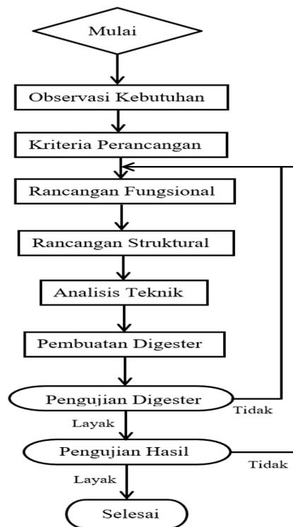
**Gambar 1.** Diagram Alir Proses Rancang-bangun Digester
