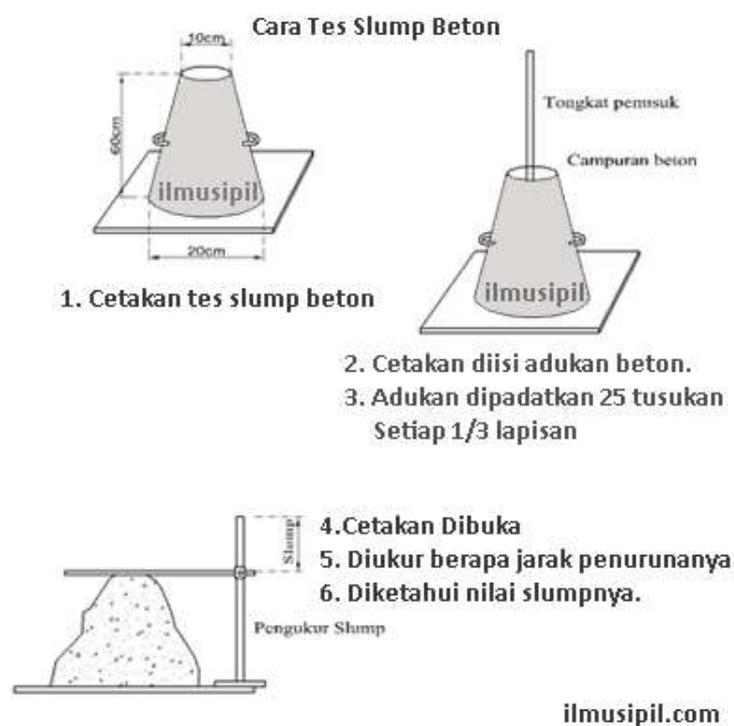
**Gambar 2.6** Bentuk Hasil Pengujian Slump
