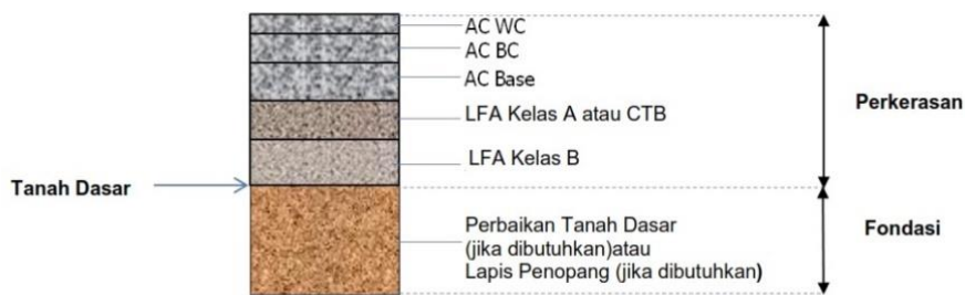
Gambar 2.24 Susunan Lapisan Perkerasan Lentur
