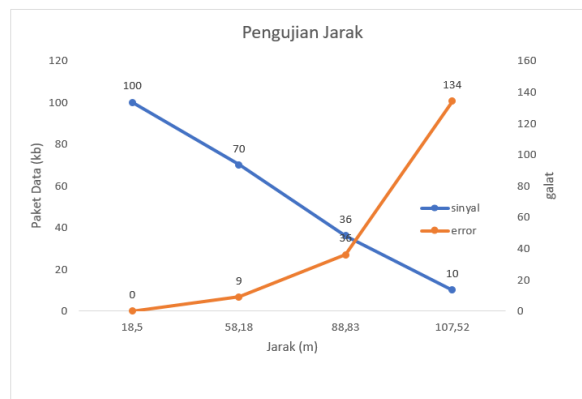
Gambar 7. Hubungan jarak dengan keberhasilan pengiriman data pada Xbee
