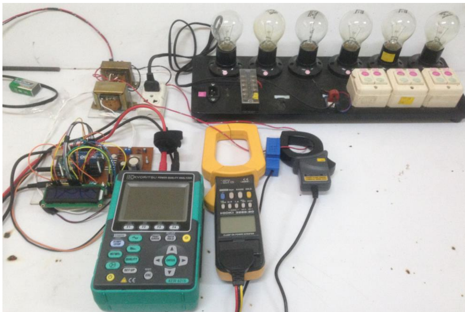
Gambar 4.6 Pengukuran Arus Listrik pada beban linear
