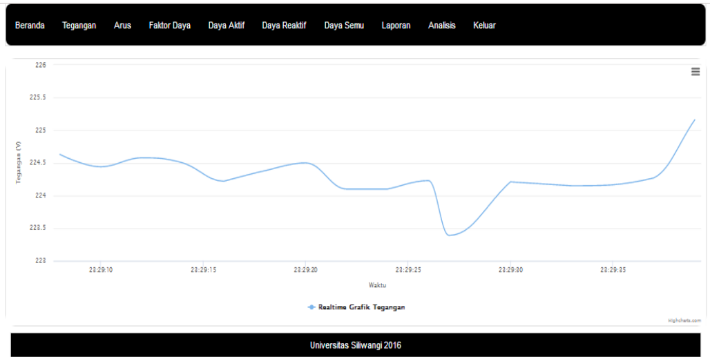
Gambar 4.27 Tampilan Antarmuka Grafik Tegangan Realtime Pada Perangkat PC/Laptop
