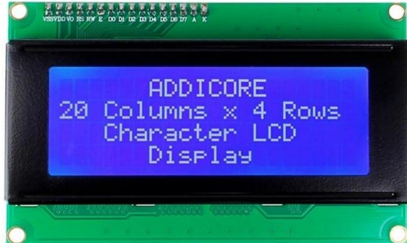
Gambar 2.23 LCD 20x4
