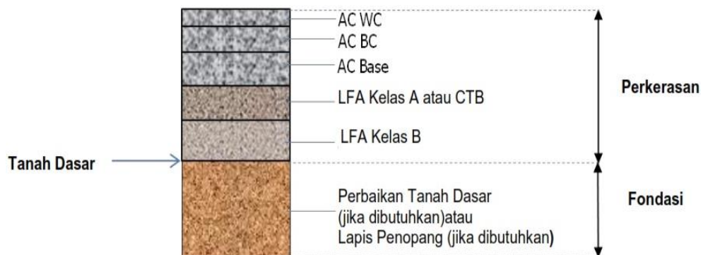
Gambar 2.10 Susunan Struktur Perkerasan Lentur
