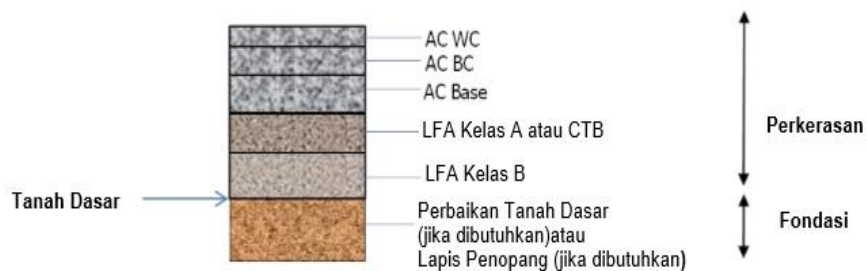
Gambar 2.16 Tipikal Struktur Perkerasan Lentur (Lalu Lintas Berat)
