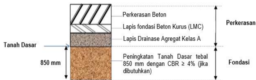
Gambar 2.17 Tipikal Struktur Perkerasan Kaku
