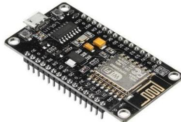
Gambar 2.1 Board NodeMCU. (<https://eprints.akakom.ac.id/> diakses pada 16 April 2020)
