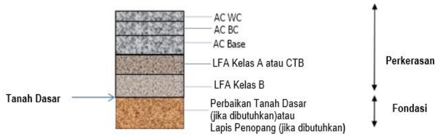
Gambar 2. 24 Tipikal Struktur Perkerasan Lentur (Lalu Lintas Berat)
