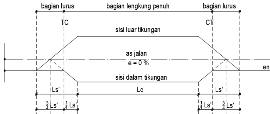
Gambar 2. 3 Diagram superelevasi berdasarkan Bina Marga pada tikungan Full Circle (lingkaran penuh)
