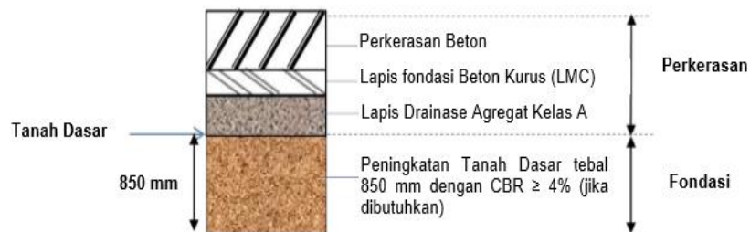
Gambar 2. 25 Tipikal Struktur Perkerasan Kaku
