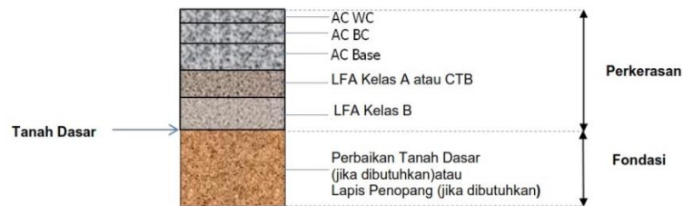
Gambar 2. 22 Susunan lapisan perkerasan lentur
