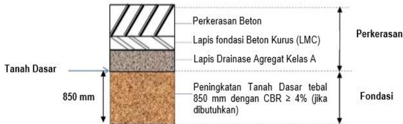
Gambar 2. 39 Struktur Perkerasan Kaku
