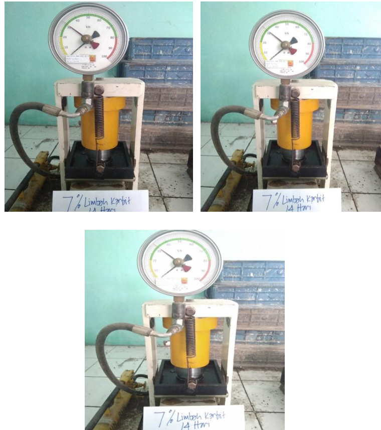
Gambar 3.21 Pengujian Kuat Lentur Beton Umur 14 Hari Dengan Bahan Tambah Limbah Karbit 7 %
