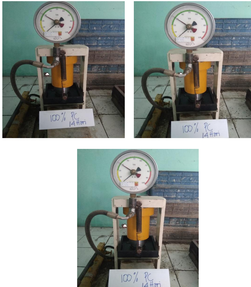
Gambar 3.18 Pengujian Kuat Lentur Beton Murni Umur 14 Hari
