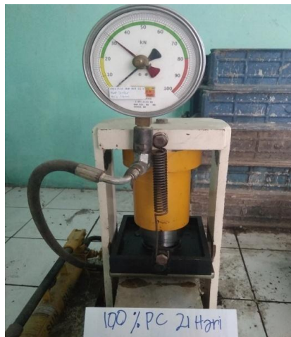
Gambar 3.19 Pengujian Kuat Lentur Beton Murni Umur 21 Hari
