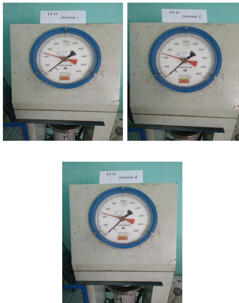
Gambar 3.28 Hasil Pengujian Kuat Tekan Beton Silinder Murni Umur 14 Hari
