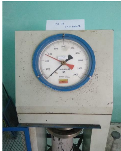
Gambar 3.30 Hasil Pengujian Kuat Tekan Beton Silinder Murni Umur 28 Hari
