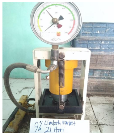
Gambar 3.25 Pengujian Kuat Lentur Beton Umur 21 Hari Dengan Bahan Tambah Limbah Karbit 9%
