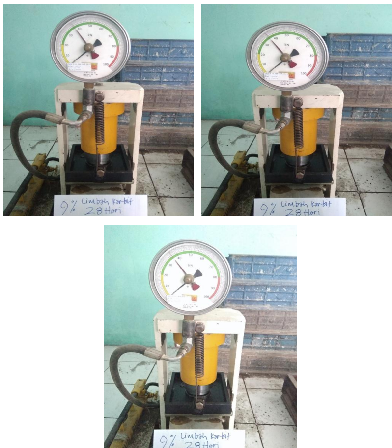
Gambar 3.26 Pengujian Kuat Lentur Beton Umur 28 Hari Dengan Bahan Tambah Limbah Karbit 9%
