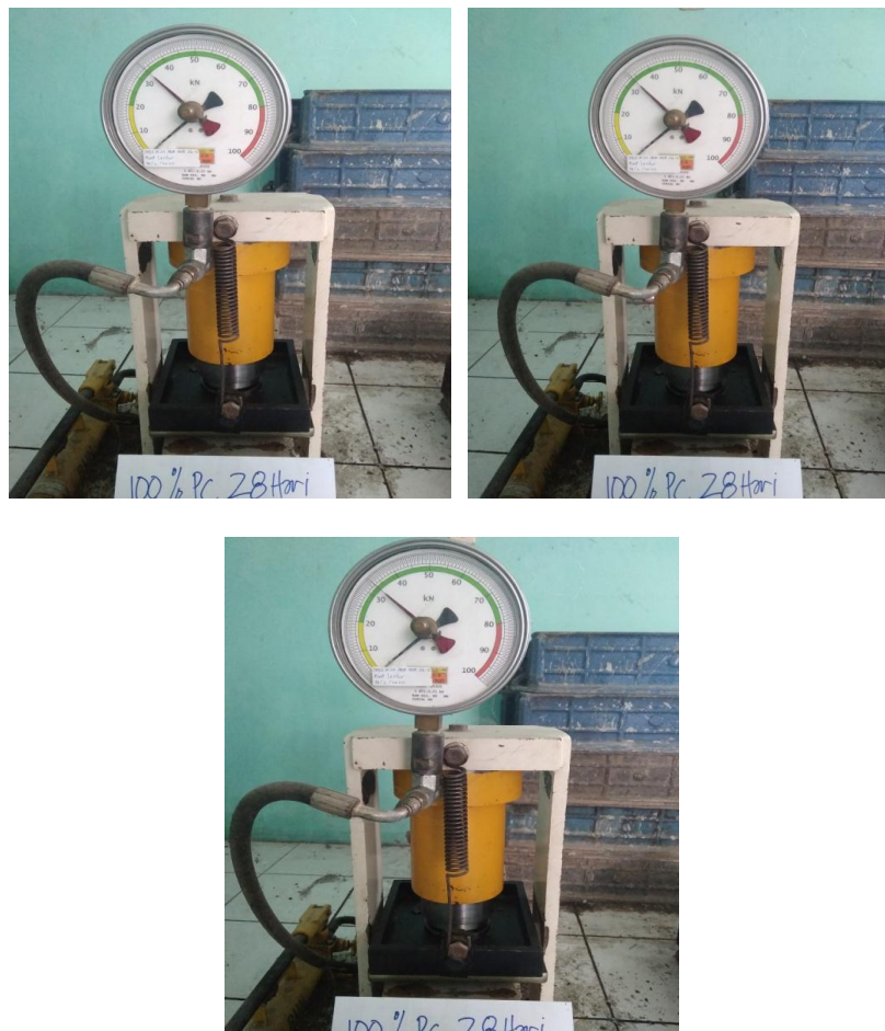
Gambar 3.20 Pengujian Kuat Lentur Beton Murni Umur 28 Hari
