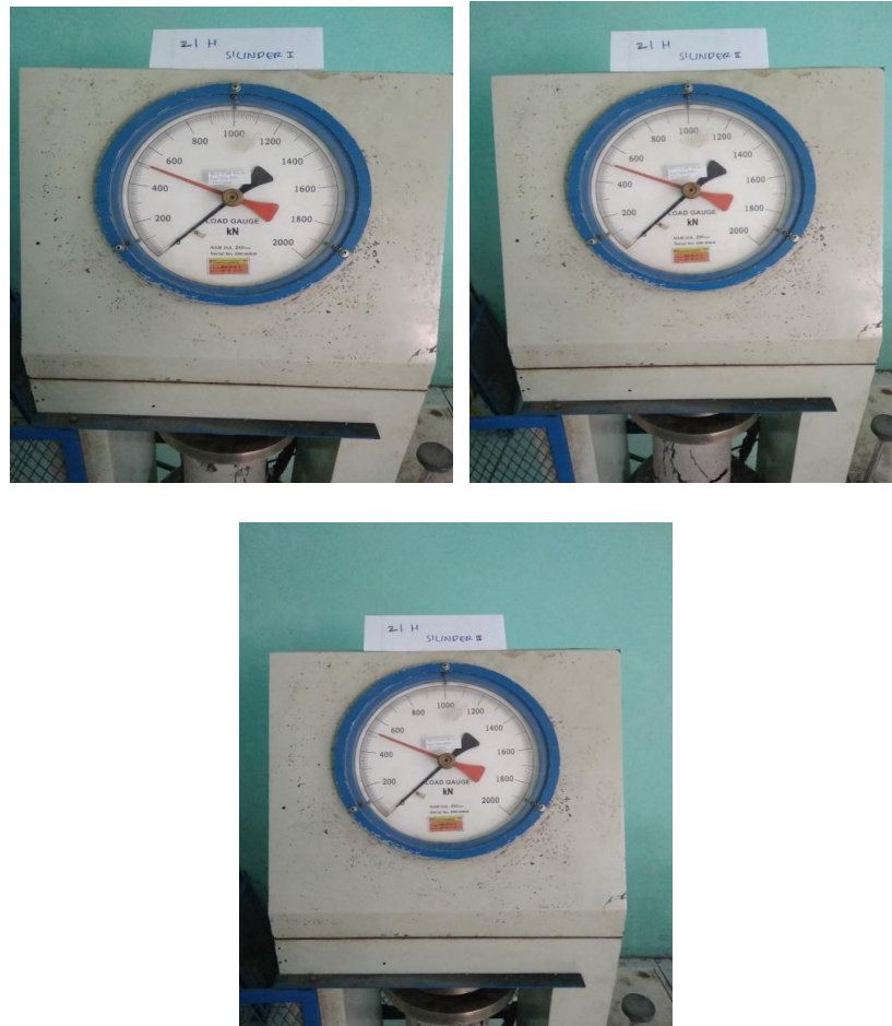
Gambar 3.29 Hasil Pengujian Kuat Tekan Beton Silinder Murni Umur 21 Hari
