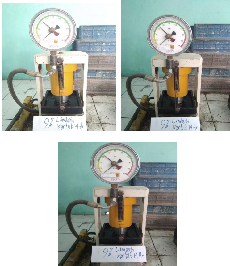
Gambar 3.24 Pengujian Kuat Lentur Beton Umur 14 Hari Dengan Bahan Tambah Limbah Karbit 9%
