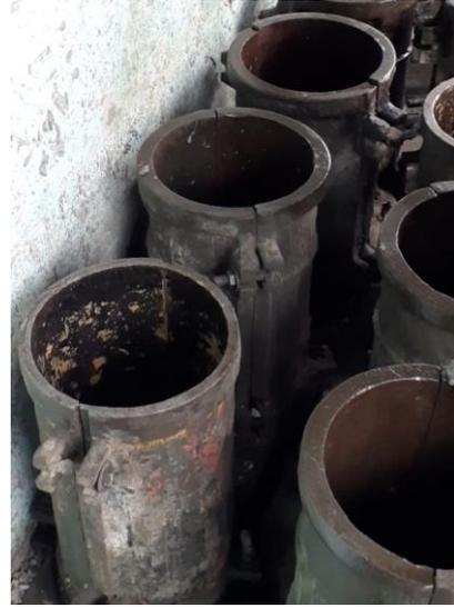
**Gambar 3. 14** Cetakan Benda Uji
