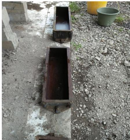
**Gambar 3.5** Cetakan Beton
