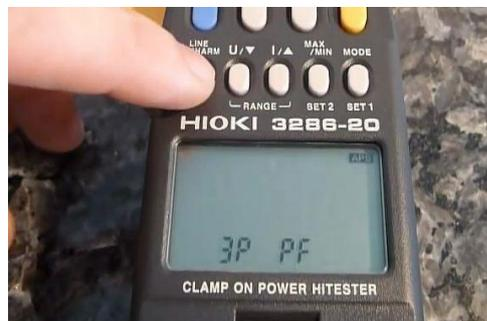
Gambar 3.2 Pengaturan Mode Pengukuran 3 Fasa Pada Alat Ukur
