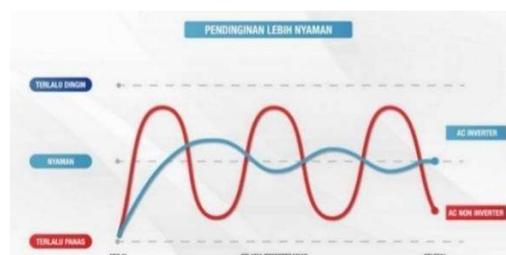
Gambar 2. 8 SiklusPerbandingan Proses Pengoperasian AC
