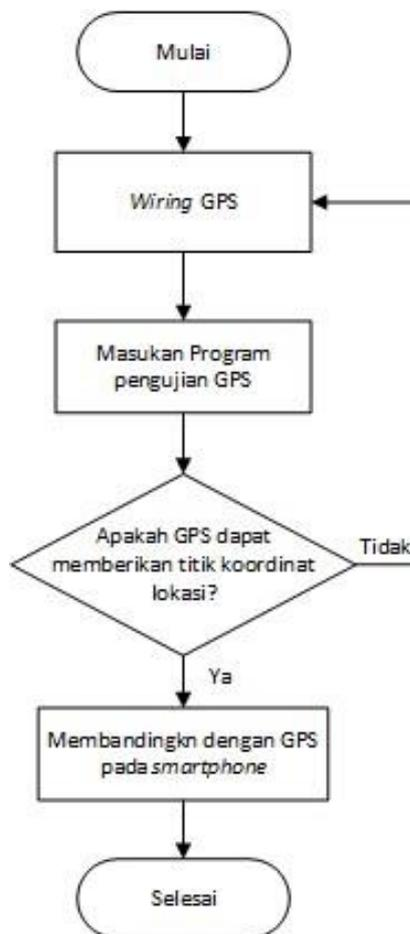
Gambar 3. 16 *Flowchart* Pengujian GPS
