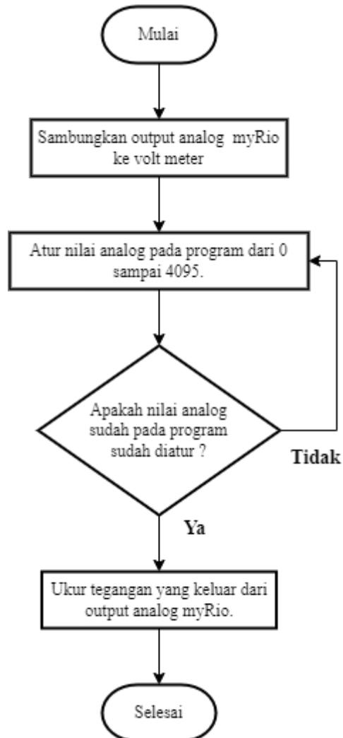
Gambar 3.5 Pengujian MyRio Menghasilkan Output Analog
