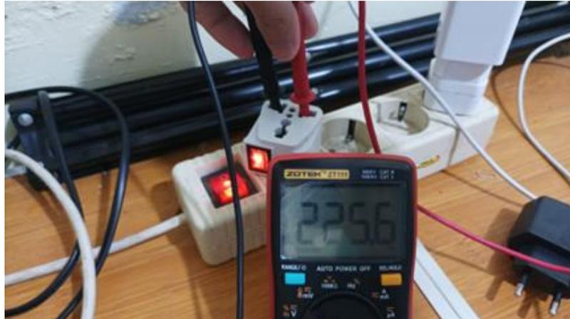
Gambar 3.7. Pengukuran Tegangan Sumber *Charger*
