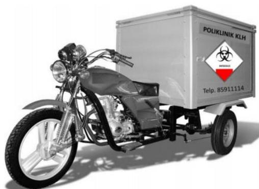
Gambar 2.15 Contoh pemberian simbol pada alat angkut roda tiga
