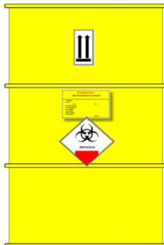
Gambar 2.13 Label identitas limbah B3 pada drum
