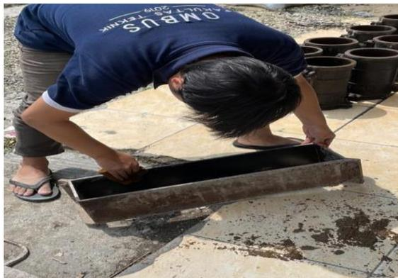
**Gambar 3.7 Cetakan Benda Uji**
