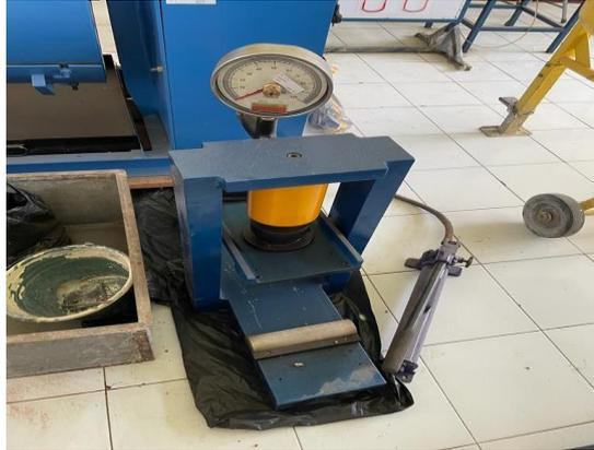
**Gambar 3.18** Alat Pengujian Kuat Lentur
