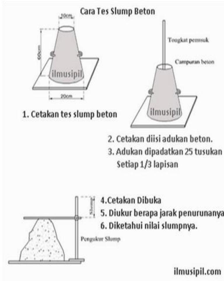
**Gambar 2.10** bentuk hasil pengujian slump
