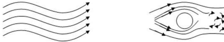
**Gambar 2. 1 Aliran garis arus atau aliran laminar dan aliran turbulen**
