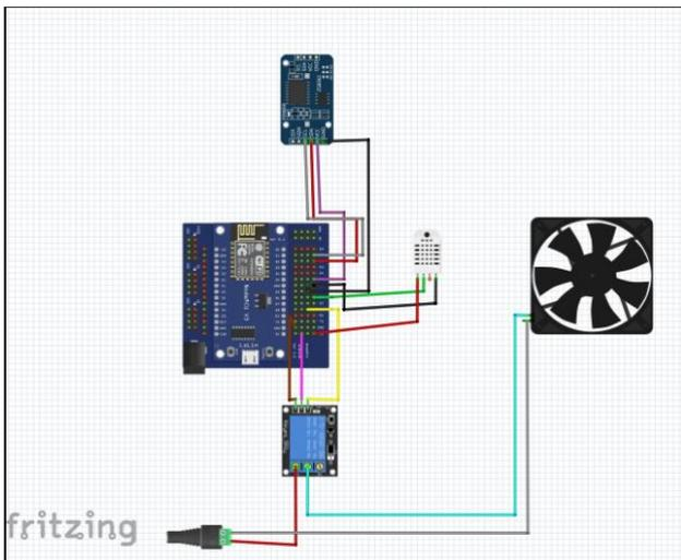
Fig. 9 Hardware Schema
