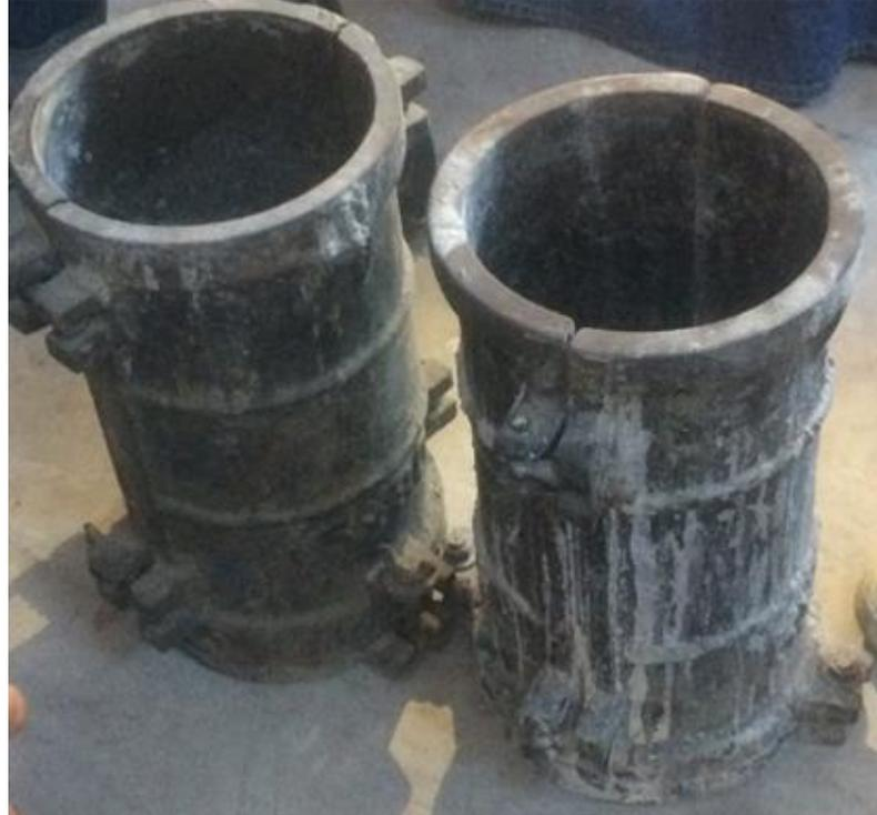
Gambar 3. 4 Cetakan Silinder
