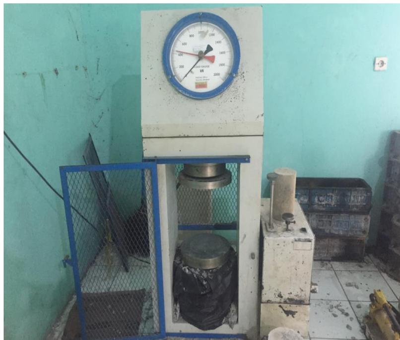
Gambar 3. 9 Mesin Uji Kuat Tekan Beton
